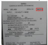
For the serial tag shown to the left the web controller would be accessible at: <a href="http://espec-06ic515/">http://espec-06ic515/</a> on windows and <a href="http://espec-06ic515.local">http://espec-06ic515.local</a> on apple devices or Linux computers.
